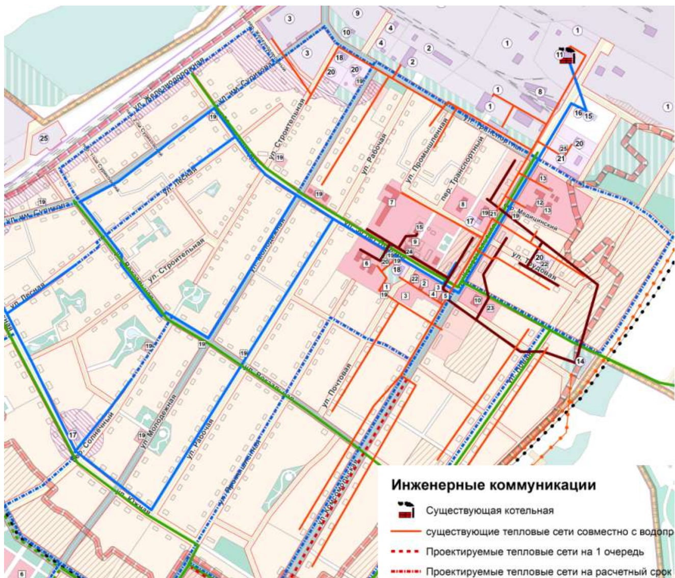
Рис. 1.3.2.6 Схема тепловой сети от Котельной в п. Рассвет
